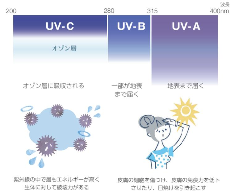
紫外線は波長の長さによって3つに分類されます。UV-A (315~400nm) は生活紫外線とも呼ばれ、波長が長く家や窓ガラスも透過するため、浴びるとゆっくり肌が黒くなります。UV-B (280~315nm) はそれより短い波長で屋外での日焼けの原因とされ、長い時間浴びると肌が赤く炎症を起こします。UV-C (200~280nm) は最も波長が短く、オゾン層に吸収されるため私たちが浴びることはありません。とてもエネルギーが強く生体に対して与える影響が大きいので、このエネルギーを利用してさまざまな除菌に利用されています。
